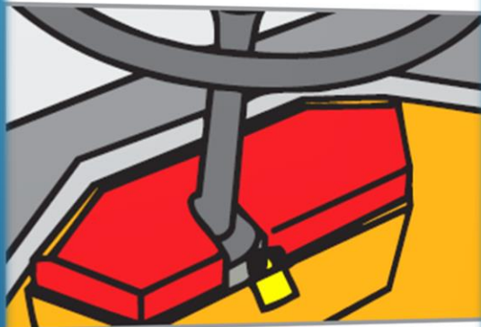
Verschließbare Abdeckung als Schutz gegen unbefugtes Ingangsetzen.
